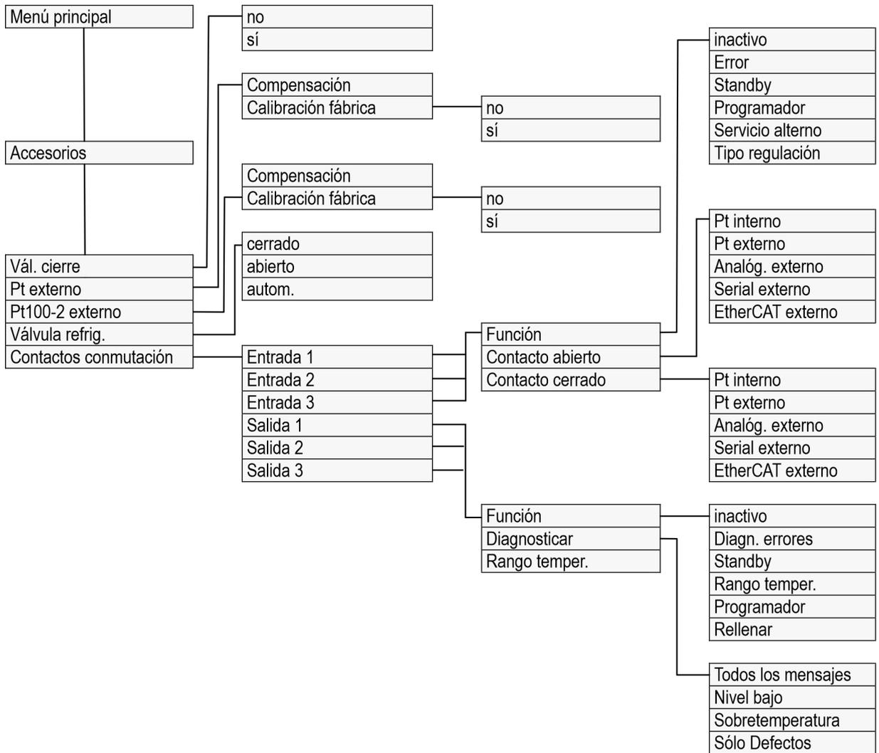
Fig. 52: Estructura de menú parte 5, MAX y PRO
