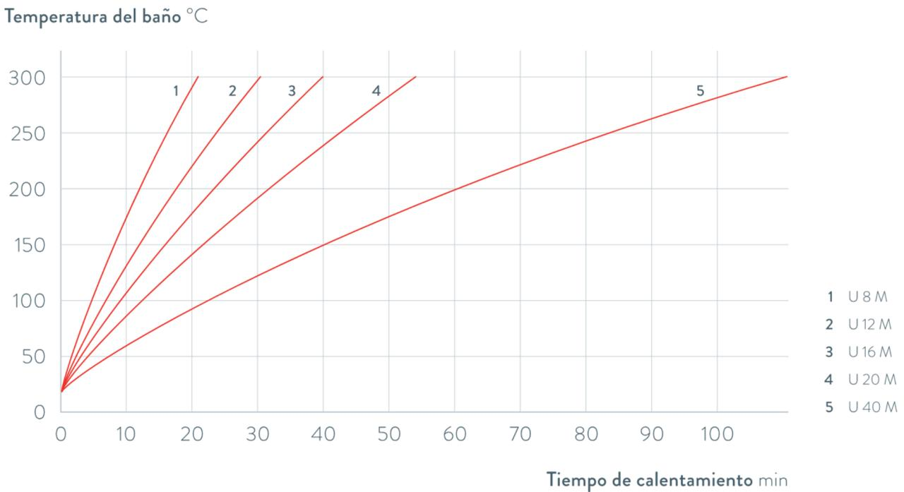
Fig. 75: Curvas de calentamiento para termostatos de calefacción Universa MAX
