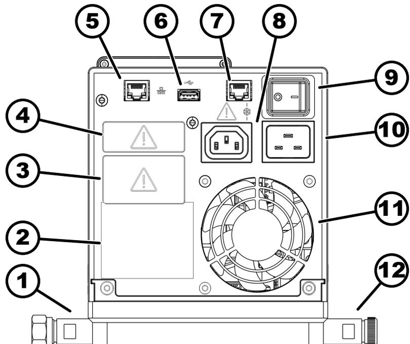
Fig. 10: Unidad de bombeo y regulación Universa PRO, vista posterior
