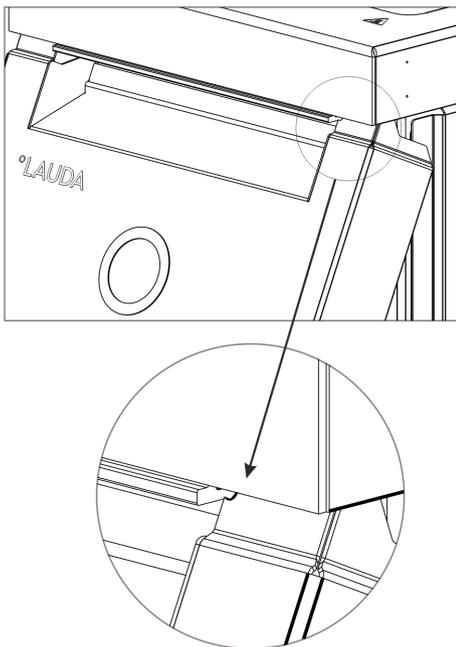
1. Sujete el panel frontal por los laterales, incline el borde superior hacia el equipo y deslice el borde debajo del borde del baño.
