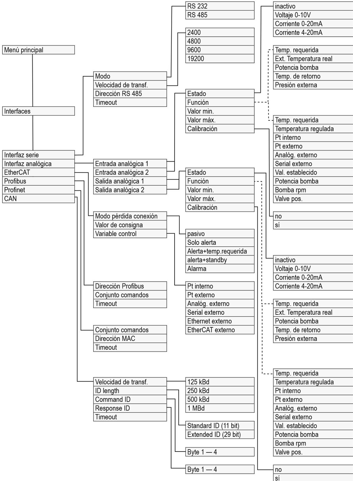
Fig. 51: Estructura de menú parte 4, MAX y PRO
