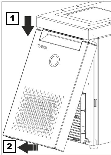
1. Sujete el panel frontal por los laterales y deslícelo hacia abajo (1).
