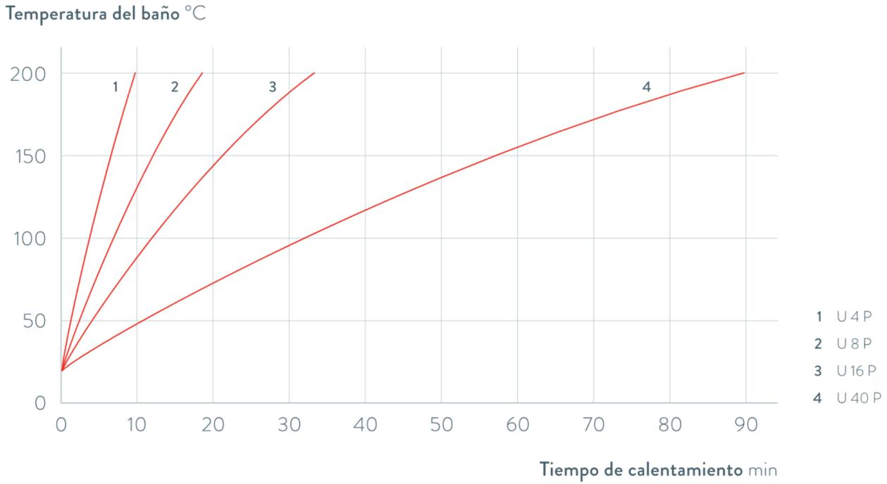
Fig. 74: Curvas de calentamiento para termostatos de calefacción Universa PRO
