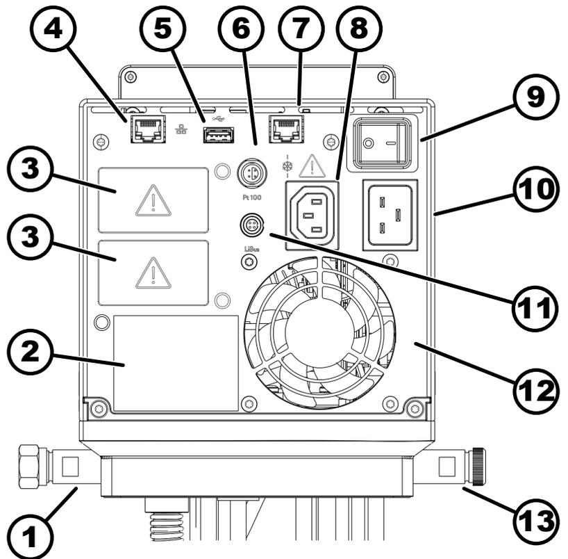
Fig. 3: Unidad de bombeo y regulación Universal MAX, vista posterior
