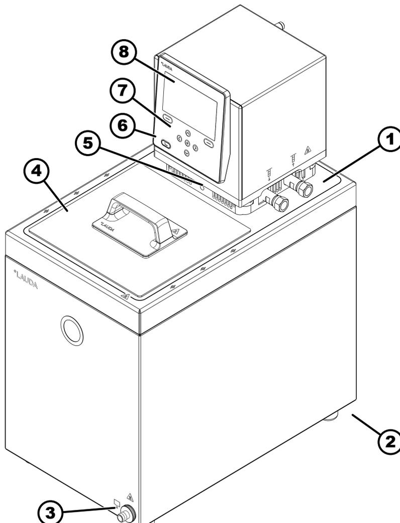
Fig. 5: Termostato de calefacción MAX, vista frontal
